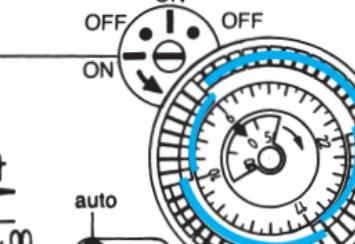
\* Quarzwerk läuft bei angelegter Spannung nach wenigen Minuten von selbst an. Die volle Gangreserve wird nach ca. 3 Tagen erreicht.
